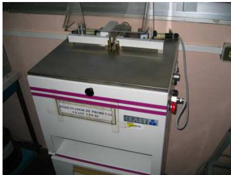
Figura 5.5: Equipo utilizado para raspar el material de manera que se adecuara al molde de la ASTM.
