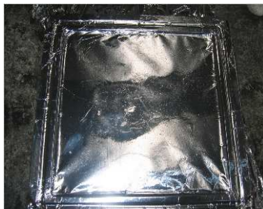
Figura 8.1: Placa metálica cubierta con aluminio para evitar la adhesión del material fundido a la misma.
