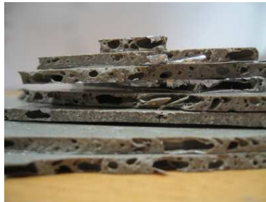
Figura 10.1: La fragilidad de algunas placas se debía a la porosidad.
